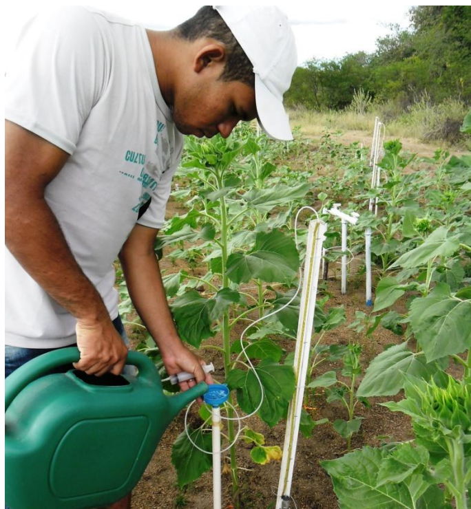
Figura 4- Realização da manutenção dos tensiômetros, com auxílio de um funil e água destilada.
