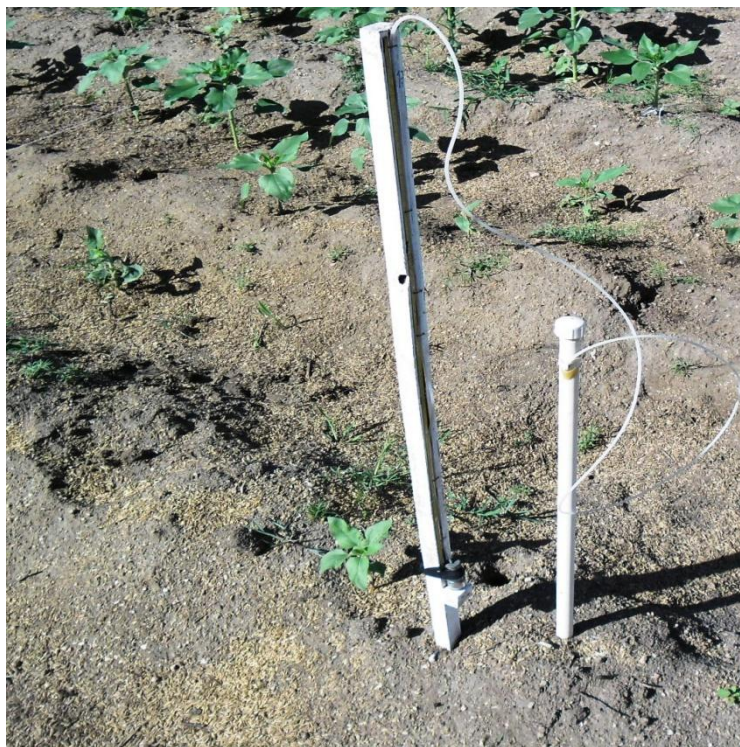
Figura 3- Tensiometro instalado na área utilizado para verificação da umidade do solo.
