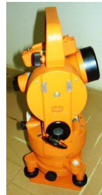
Figura 3 - Teodolito mecânico TE-D43 da MOM
