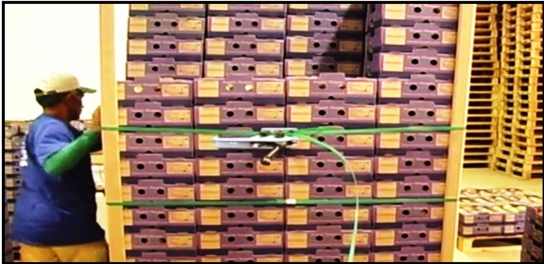
Figura 6 – Funcionário executando a amarração das caixas para garantir a firmeza destas nos pallets.
