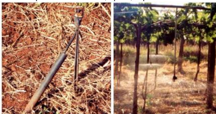
Figura 5 — Microaspersores fixados ao solo (esquerda) e operando de forma invertida (direita).
