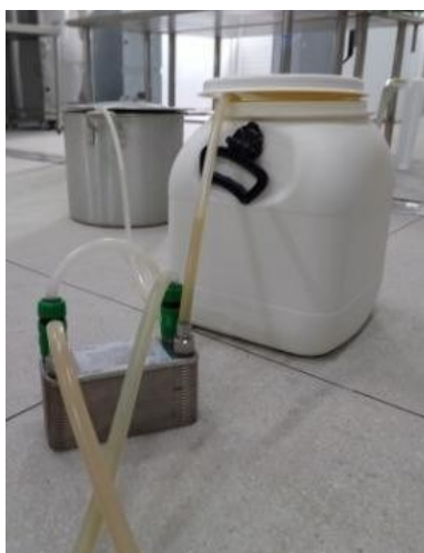
Figura 15 - Chiller com mangueiras.
