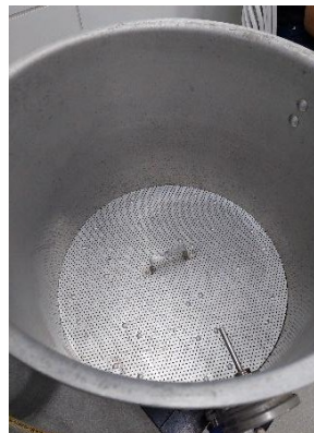
Figura 3 - Caldeirão de fundo falso
