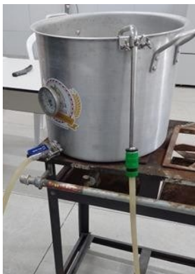
Figura 9 - Estrutura do caldeirão com a bomba.
