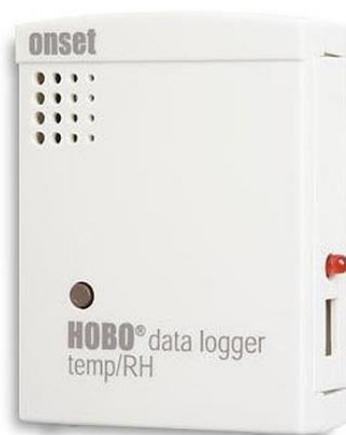
Figura 3 - Termo-higrometro HOBO U-10 utilizado na pesquisa. Fonte:
