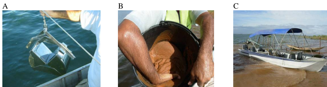
Figura 1 – Coleta de sedimentos: (A) draga modelo Petite Ponar e (B) homogeneização do sedimento dos pontos C,M,J e (C) Barco tipo voadeira, equipada com motores Yamaha de 25 e 40 HP. (CHESF, 2008).
