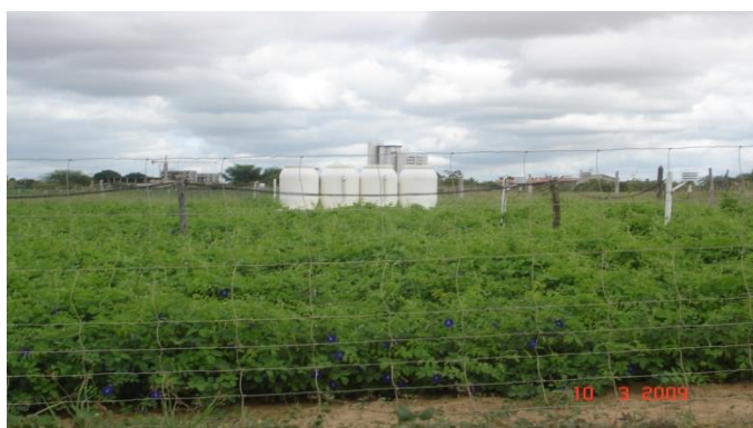
Figura 1. Área experimental contendo estrutura de evapotranspirômetros de lençol freático constante
