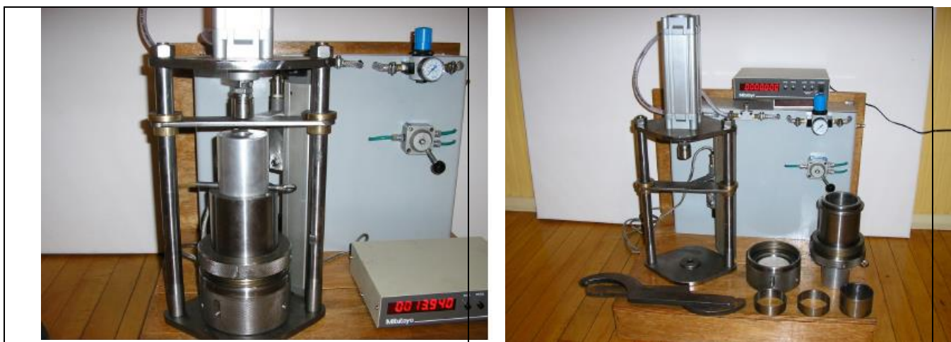
Figura 2. Oedometro para compressão uniaxial de amostras de solo
