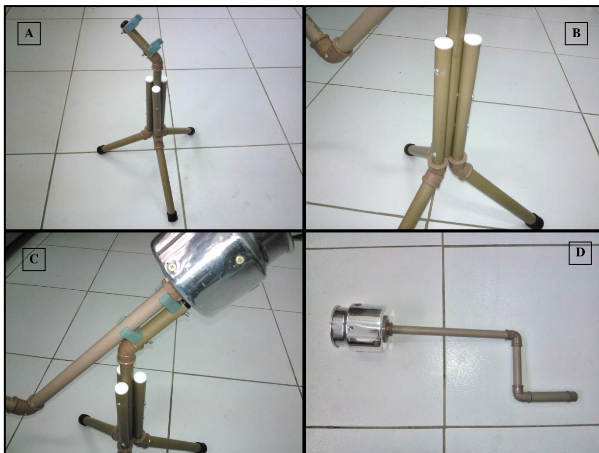
Figura 01. Visão da: parte de sustentação (A); união das três partes de sustentação ao tubo central (B); parte de giro, fixada por abraçadeiras plásticas de pressão à parte de sustentação (C); parte de giro e tambor unidas.
