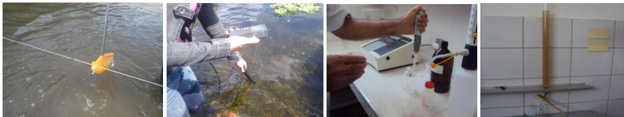
Figura 2: (A) Obtenção de amostra de água utilizando amostrador DH-48; (B) Medição do Oxigênio Dissolvido utilizando o oxímetro; (C) Determinação de Nitrogênio e (D) Análise granulométrica e de concentração de sedimentos em suspensão por tubo de remoção pela base. Fonte: Autor, 2013.
