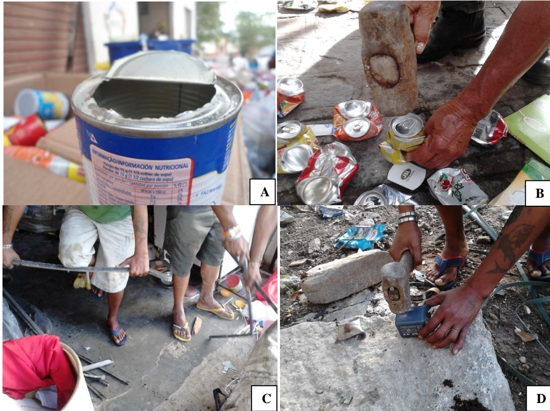
Figura 4. Exemplo de material com evidência ao risco físico de corte e perfuração A ; Atividade de compactação de latinhas de alumínio B ; Trabalho com ferragens que exige compactação para devido armazenamento C ; Extração de fios de cobre em desmanche de transformador elétrico D . Fonte: Fábio Giovanni.
