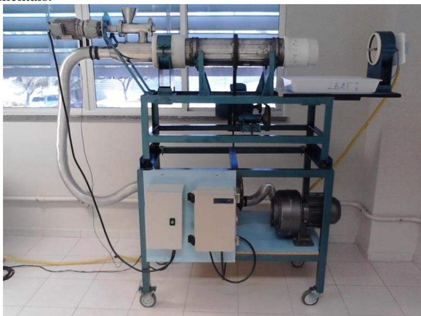
**Figura 1** - Configuração do Secador Rotatório
