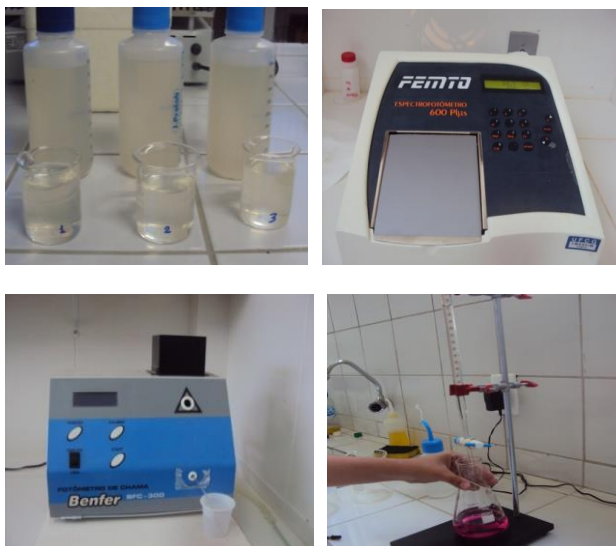
Figura 3 – Análises dos parâmetros Físico-químicos. (A): Amostras de água coletadas, (B): Determinação de N e P total, (C): Determinação de Na e K e (D): Determinação de Ca e Mg.
