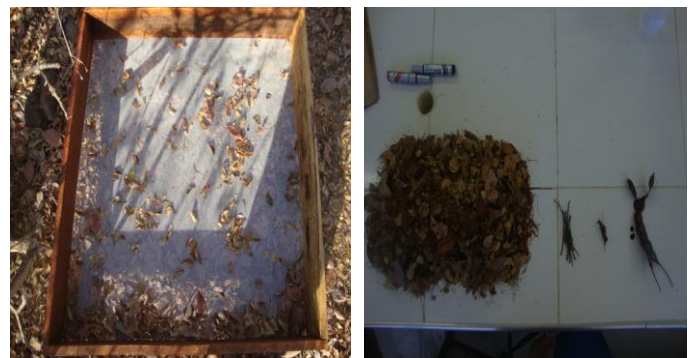
Figura 1. Caixa coletora utilizada nos estudos de deposição (a) e separação das frações folhas, galhos, estruturas reprodutivas e miscelânea (b). Pombal, PB. 2014.
